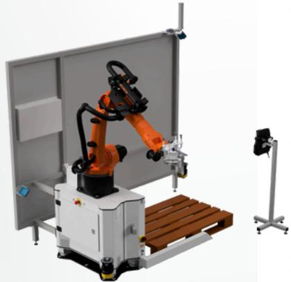
Müheleose Einstellung der Arbeitsplattform im Bereich von 0 mm bis 687 mm in 40 mm-Abständen.
